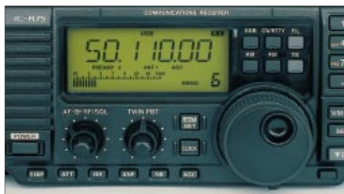
Bild 5: Diese Detailsicht der Frontpartie läßt insbesondere das sehr exakt anzeigende S-Meter erkennen, welches eine Spitzenwertanzeige („Peak Hold“) aufweist.
